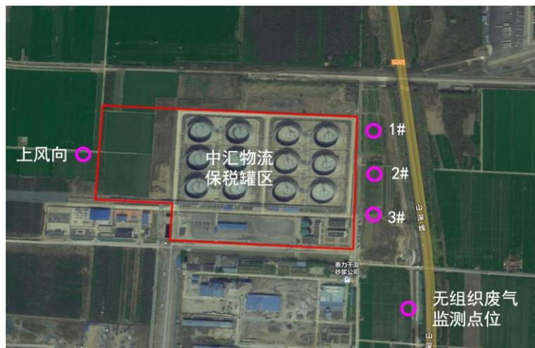
图3 保税罐区厂界无组织废气监测布点图
